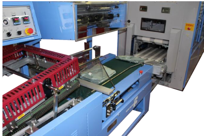
ユニフォームフォルダーWFO-JUMP-HGと連結した自動包装ライン
