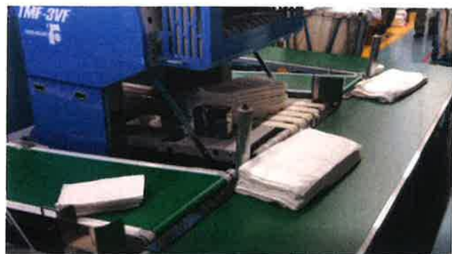
▲コンベアシステムにて一括搬送
