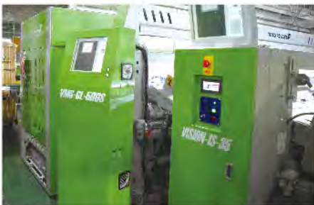
●リネン類裏面検査装置「VISION」
