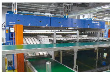
●シャツ専用たたみ機「VS1V-N6-35KJ」
