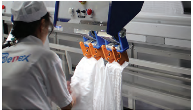
▲従来のように、2つのクランプが同時に上昇するモード変更も可能。▲各ステーションに切替スイッチがあり、3名それぞれ自分に合った投入方法が選択できる。
