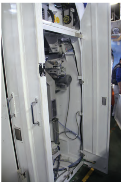
◀ 工具不要で簡単に開閉できるサイドカバーにより、メンテナンスや内部の掃除が簡単に行える
