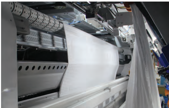
▲品物の全面を抑える4分割開閉ストッパーを採用
