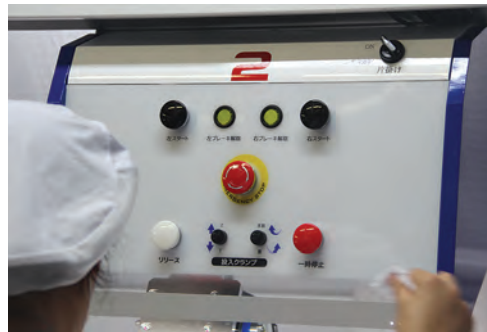
▲従来のように、2つのクランプが同時に上昇するモード変更も可能。▲各ステーションに切替スイッチがあり、3名それぞれ自分に合った投入方法が選択できる。
