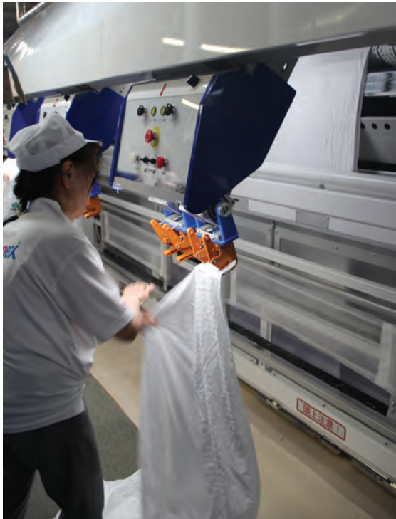
▲クランプ部分がLEDライトで明るくなっているのがわかる。両端のセットが完了すると、ライトが消える。
