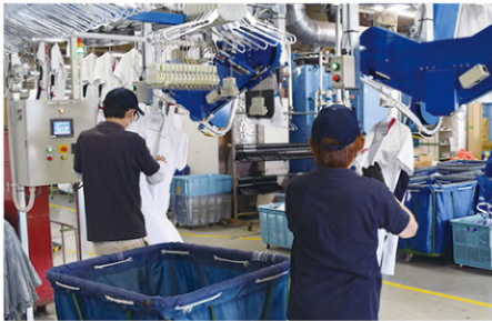
●2STACと同時にハンガーキャッチャーとトンネルフィニッシャーを導入
